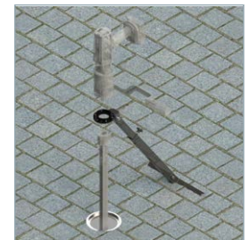
Beispiel: Drehmomentstütze an einer Einbaugarnitur.
